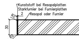
**Platte E:** 30 mm stark, aus 28 mm Mehrschichtgütespanplatte E1, Plattenoberseite wahlweise Kunststoff HPL oder Furnier nach BRUNE®-Kollektion. Plattenunterseite HPL weiß bzw. Buche Furnier. Kante Buche-Massiv-Einleimer, ballig gefräst, 9 mm stark.
